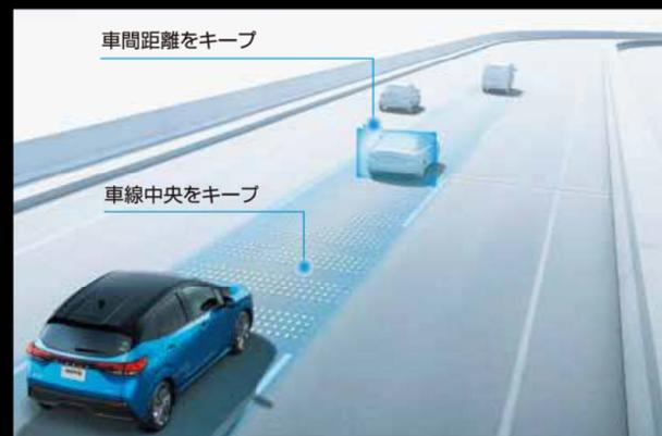
高速道路で運転中、アクセル、ブレーキ、ステアリングをクルマがアシスト。車両停止後も約30秒まで追従走行を継続。
